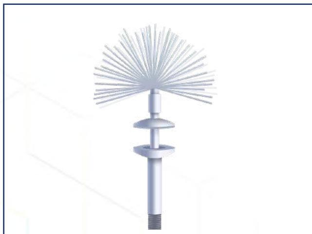
Figura 3 – Representação de Captor Charge Transfer System (CTS).
